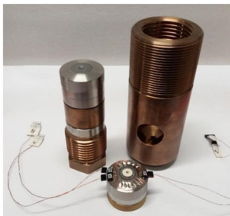
Рис. 4. Миниатюрная камера фиксированного давления типа «тороид» для исследования электрического сопротивления, магнитной восприимчивости, точечной контактной спектроскопии и теплоёмкости твёрдых тел при температурах 1.3-350 К и гидростатическом давлении до 6 ГПа.
