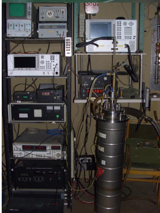
Рис. 10. ЭПР спектрометр в ИОФ РАН, созданный под руководством д.ф.-м.н., профессора, лауреата Международной премии им. Е.К. Завойского С.В. Демишева. Прибор рассчитан на частотный диапазон 40-99 ГГц и позволяет проводить эксперименты в магнитном поле до 8 Тл, в интервале температур 1.5-300 К с точностью стабилизации температуры до 3 мК.
