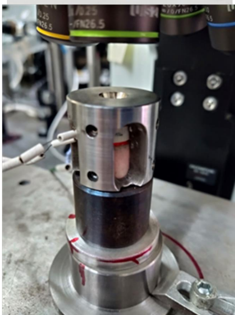
Рис. 5. Фотография ячейки с алмазными наковальнями и внешним нагревом образца (позволяет получать давление до 1 миллиона атм. при температуре до 500°C).
